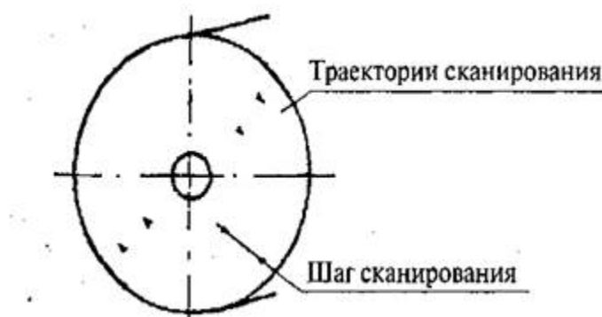
Рис. К. 3. Траектории сканирования торцевой поверхности
